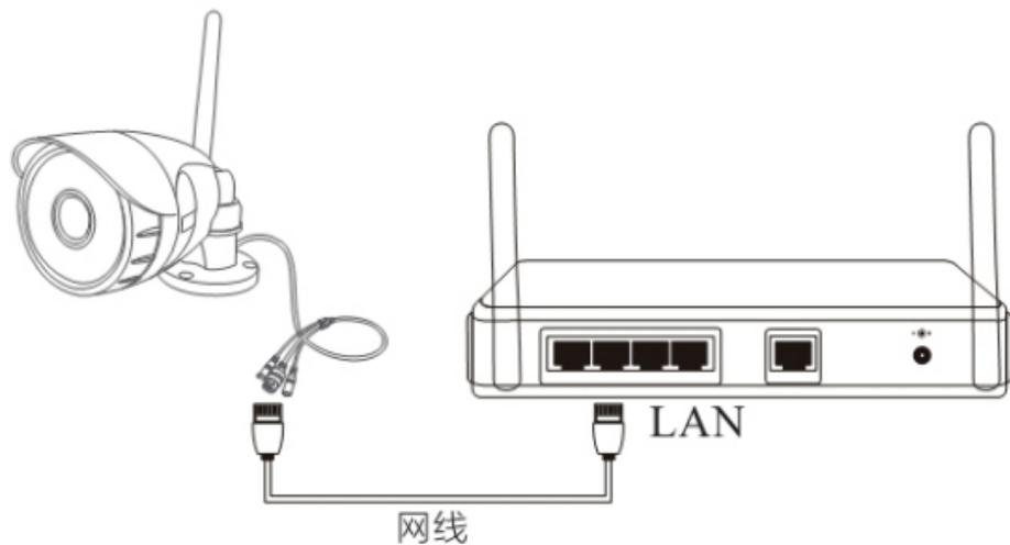
**注：**请用一根网线将摄像机连接到路由器的LAN口。
